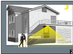
Quand la lumière ambiante est insuffisante, le capteur allume la lampe quand un mouvement est détecté.
